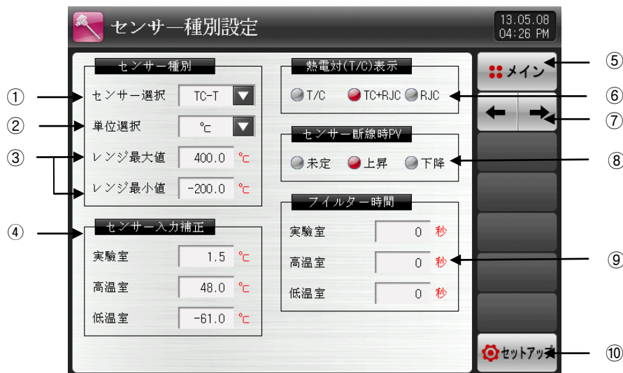
[図11-1] センサー入力設定の第1画面
