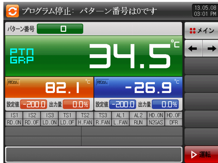
[図3-2] プログラム運転の第1停止画面
