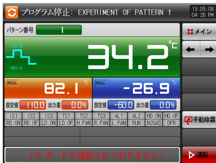
[図9-2] I/Oボードの通信エラー画面
