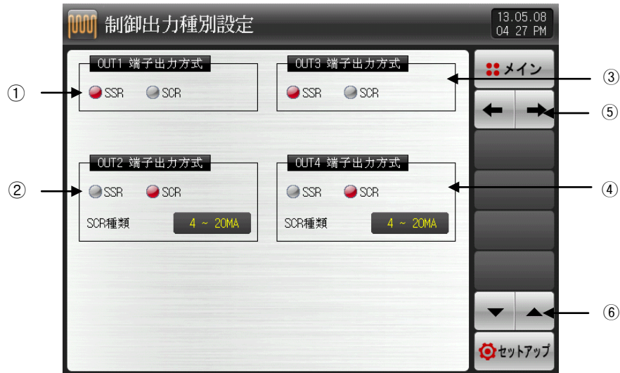
[図12-1] 制御出力設定の第1画面
