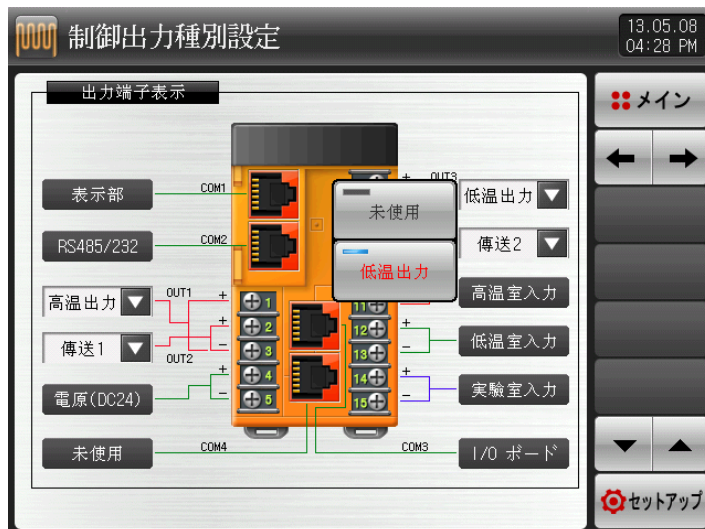
[図 12-5] SSR出力端子の設定画面
