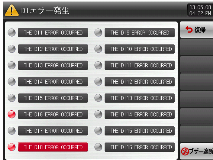
[図7-3] DIエラーの表示方式が文字である画面
