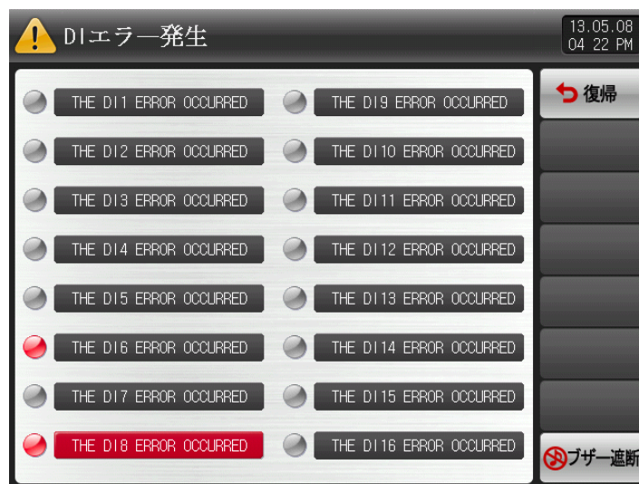
[図19-12] DIエラーの表示方式が文字である画面
