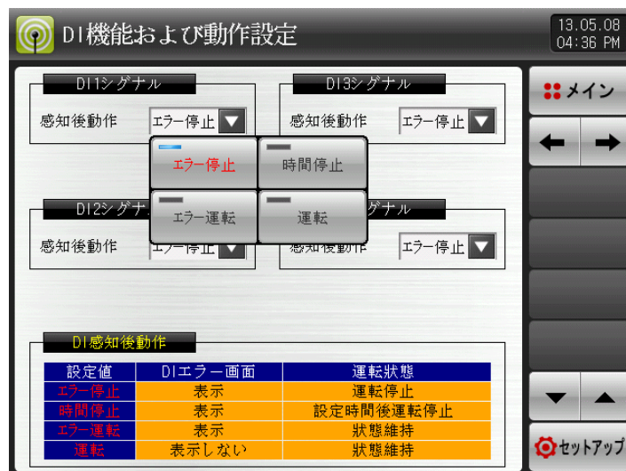
[図 19-5] DIの機能及び動作設定の第5画面 -2
