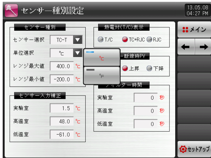
[図11-3] T/Cセンサーの表示単位選択画面
