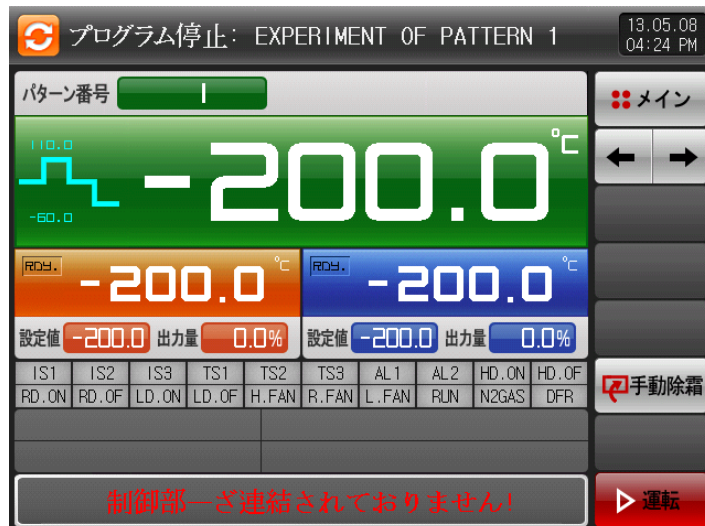
[図9-1] 制御ユニットの通信エラー画面
